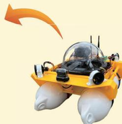
高性能ジンバルカメラ。30倍光学ズーム、デジタルズーム、4K動画撮影可。パソコン上での点検作業に最適。
