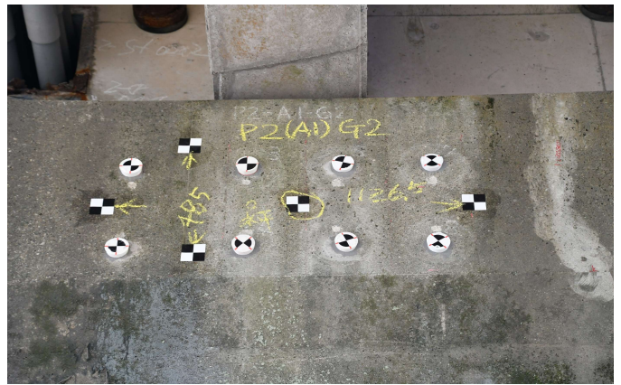
＜橋脚梁部のコア削孔＞
