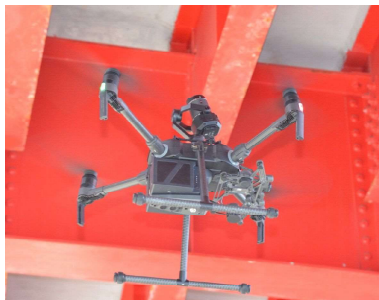
【調査用ドローンによる点検撮影】
