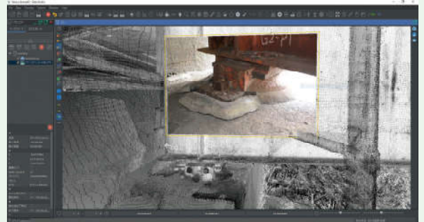
●三次元スキャナーにて得られた橋梁の点群データ上に、損傷の詳細写真を付加することで、損傷調査報告用のデータを作成しました。
